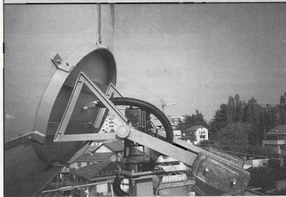
figura 3 - Parabola ancorata al rotore doppio (azimuth ed elevazione) vista laterale.
